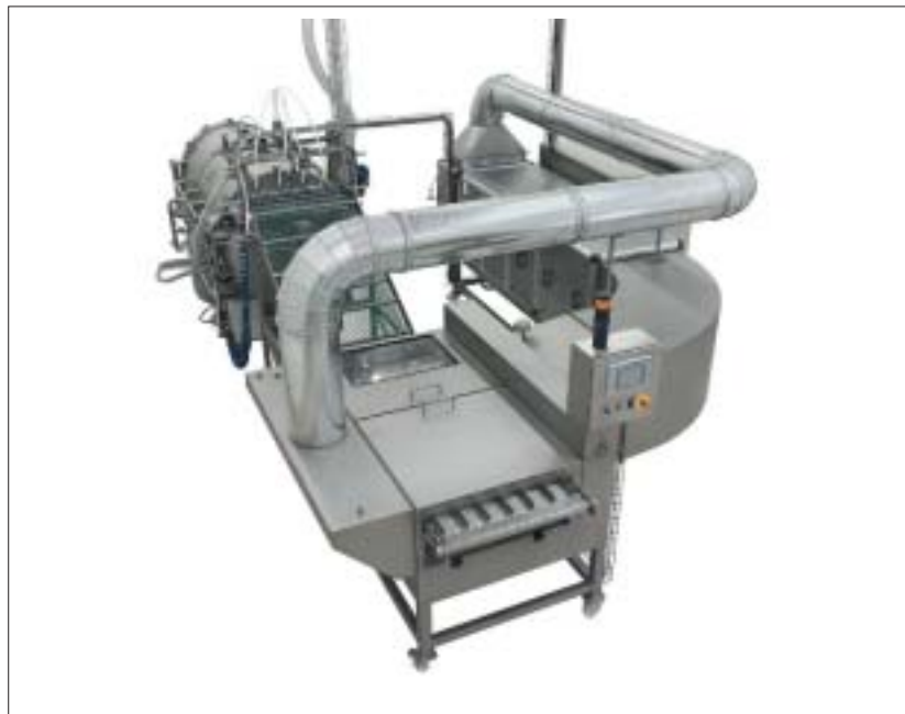
Figura 2. Equipo QDS process: 1. Etapa atemperado/presecado; 2. Etapa secado al vacío; 3. Circuito de tratamiento de aire con filtro HEPA
